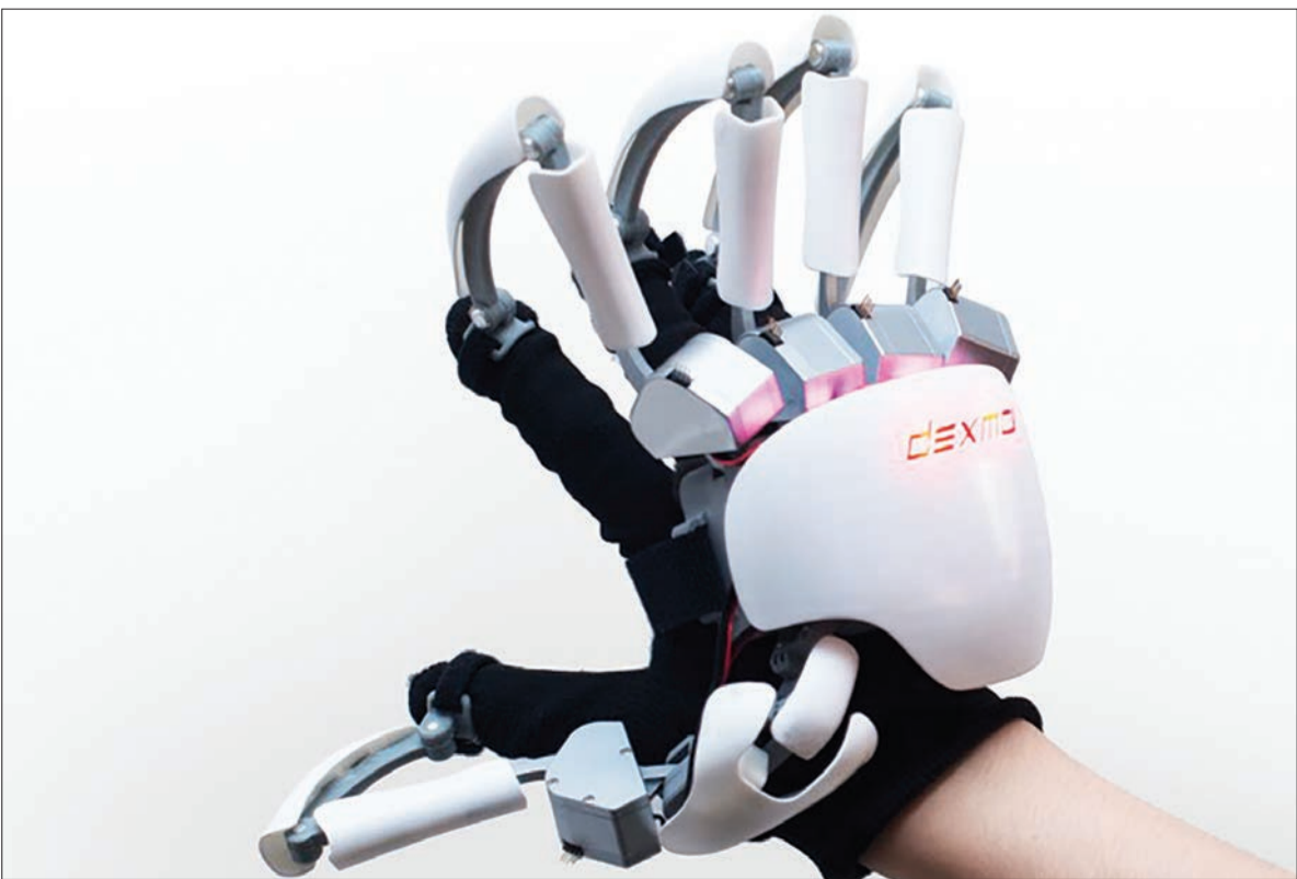
Exos VR: دستکشی است که کاربر می‌تواند با آن اشیای موجود در فضای مجازی را لمس کند. این محصول از موتورهای کوچکی تشکیل شده که می‌توانند با روشن شدن هوشمندانه، حس لمس کردن را به انگشتان القا کنند. این دستکش واقعیت مجازی هنوز به تولید انبوه نرسیده است.
