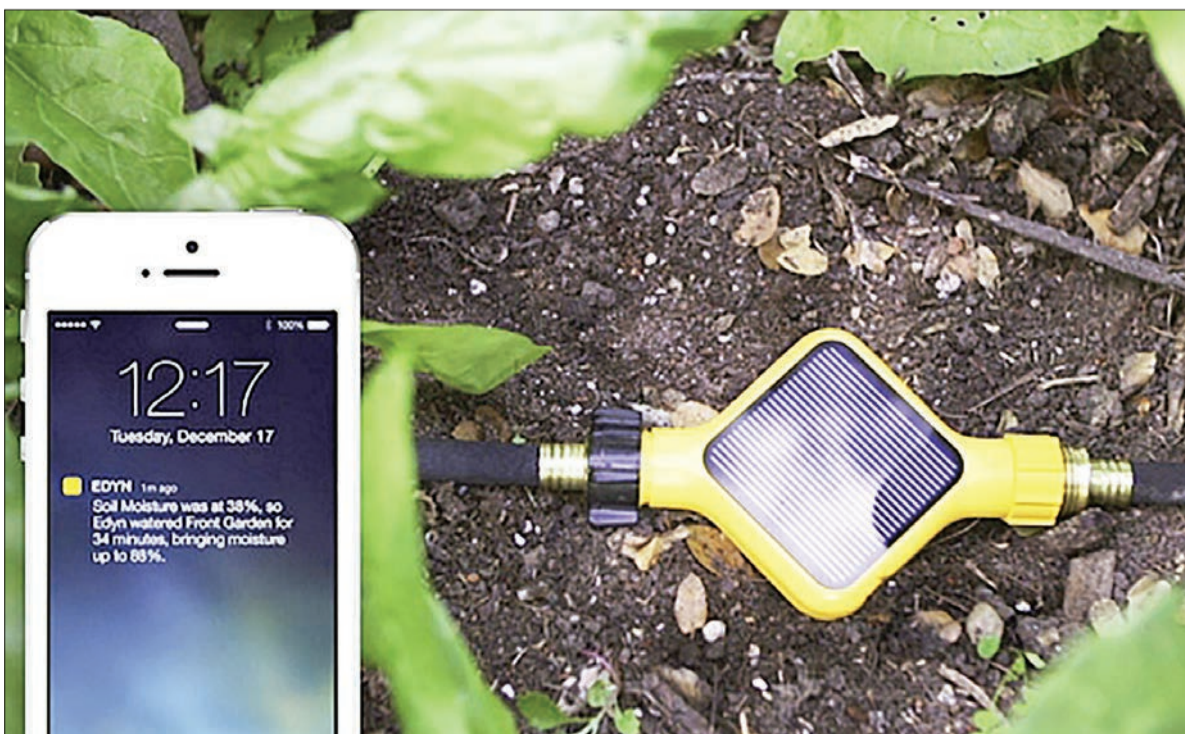
Eydin نام یک سنسور هوشمند برای سنجش وضعیت گیاهان است؛ این سنسور نه تنها وضعیت تابش نور خورشید را کنترل می‌کند، بلکه مواردی مثل رطوبت، وضعیت خاک و سایر شاخص‌های مهم کشاورزی را از طریق وای فای به تلفن همراه کاربر ارسال می‌کند. قیمت این محصول ۹۹ دلار است.
