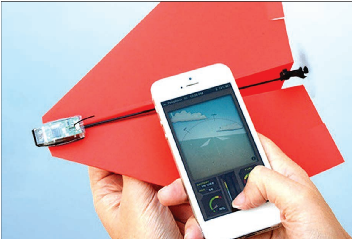
POWERUP 3.0 ، یک کیت هوشمند است که موشک‌های کاغذی را به موشک‌های هوشمند تبدیل می‌کند. در واقع این یک سیستم مازول خلاقانه و ساده است. با استفاده از این کیت هوشمند می‌توان موشک‌ها را تا ۱۰ دقیقه مداوم پرواز داد. قیمت دقیق محصول ۳۰ دلار است.
