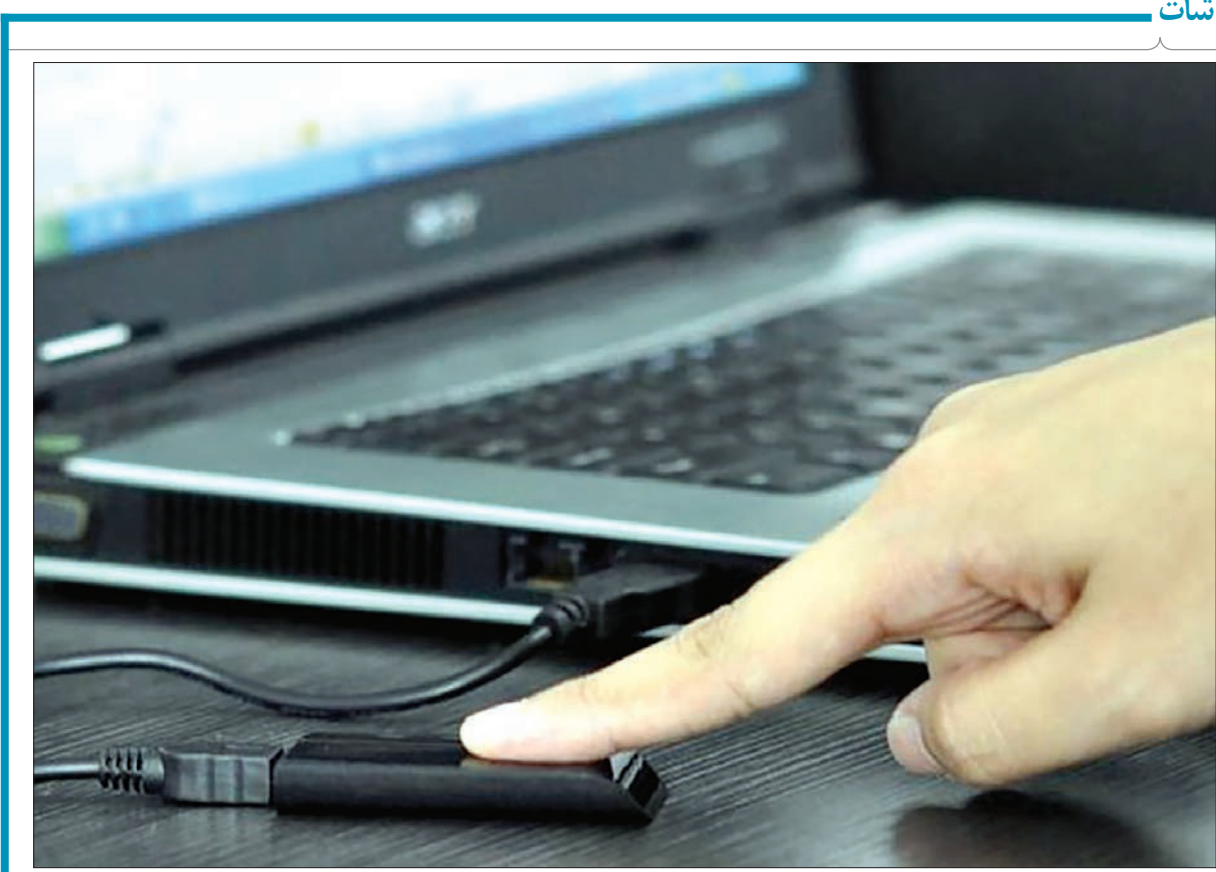
سیستم‌های اسکن اثر انگشت طرفدارانی پرشمار دارند. Fingerprint Security Scanner سیستمی مبتنی بر اسکن اثر انگشت است که با اتصال USB به رایانه شخصی فضای امنی را برای اطلاعات کاربران ایجاد می‌کند.
